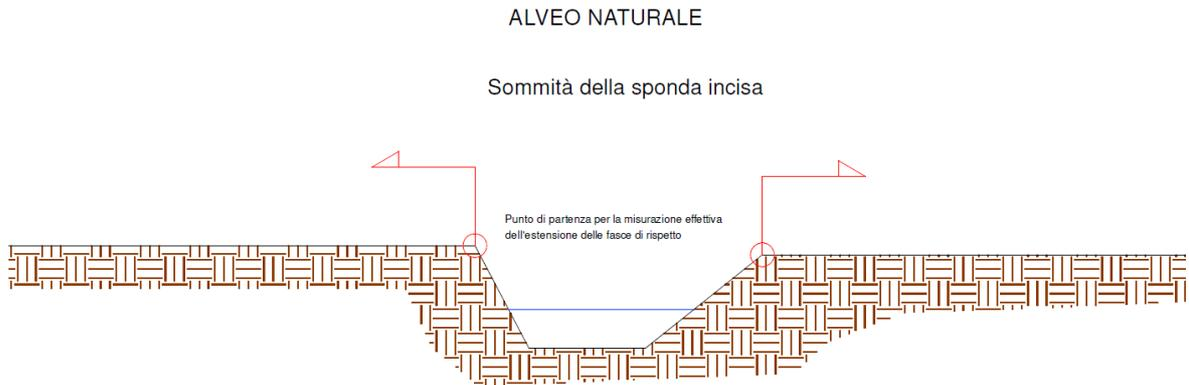
Figura 1: Punti di misurazione per la misurazione delle fasce di rispetto in alveo naturale.
